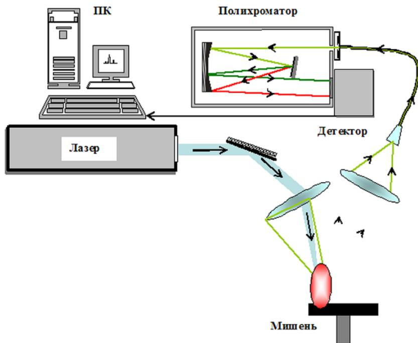
**Рис. 1.** Блок и оптическая схема лазерного спектрометра.
